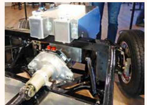
Waar normaal de versnellingsbak zit, zit nu de elektrische motor
