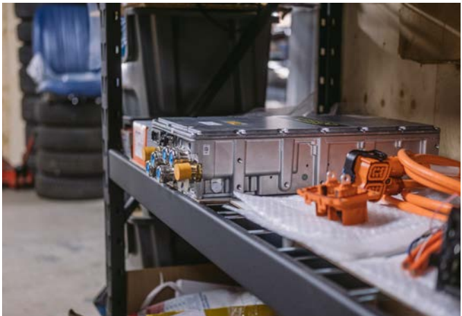
↑ VÄXELRIKTARE SOM EGENTLIGEN ÄR AVSEDD FÖR GRUVMASKINER.
