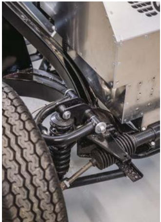
↑ ↗ HJULUPPHÄNGNING OCH FJÄDRING FÖRE OCH EFTER.
