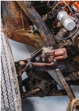
↑ ↗ HJULUPPHÄNGNING OCH FJÄDRING FÖRE OCH EFTER.
