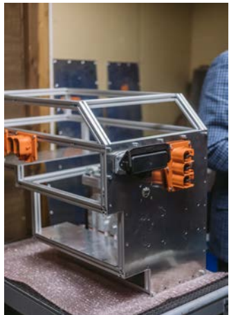
↑ ”VIRTUELL MOTOR”, ALUMINIUMLÅDA SOM RYMMER ALLA KOMPONENTER.
