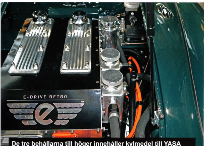
De tre behållarna till höger innehåller kylmedel till YASA P400-motorn, elektronik, och batteri.
