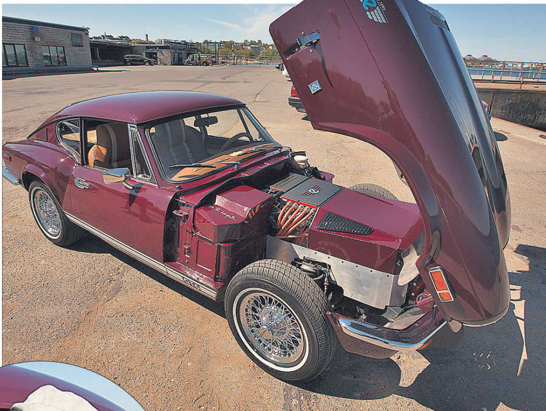
Triumphi kuuesilindrilise ridamootori asemel töötab 105kW elektrimootor, mis kiirendab nullist sajani 8,2 sekundiga.
